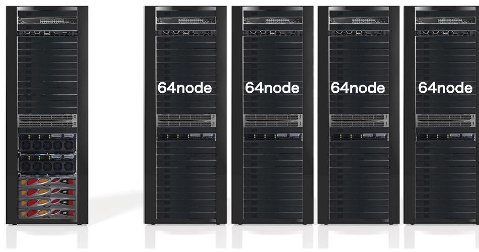
最大構成時：Grace Hopper 水冷サーバの場合
